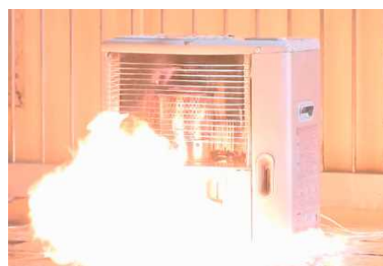
ガソリンの誤給油による発火事故の再現
