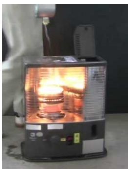
(写真) 消火せずに給油し、灯油がこぼれ引火（イメージ）
