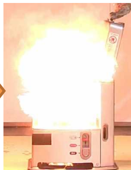
(写真) 消火後に燃焼筒の温度が高温になっており、灯油がかかり引火（イメージ）
