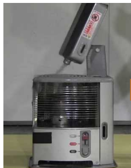
(写真) 消火後に燃焼筒の温度が高温になっており、灯油がかかり引火（イメージ）
