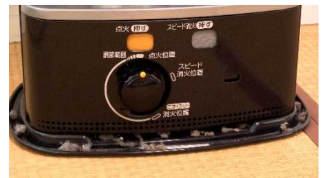
清掃不足の例（石油ストーブ）
