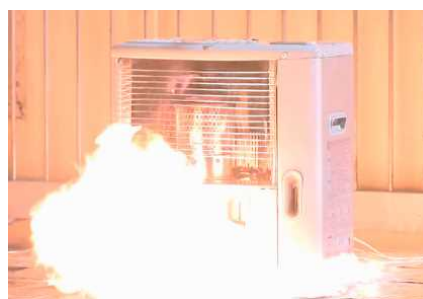
(写真) ガソリンを給油して爆発的に燃え上がる様子 (イメージ)
